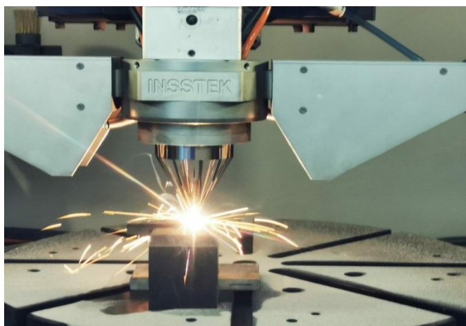
Рисунок 3 – Процесс создания корпуса фрезы с помощью технологии SLM (Selective Laser Melting)
