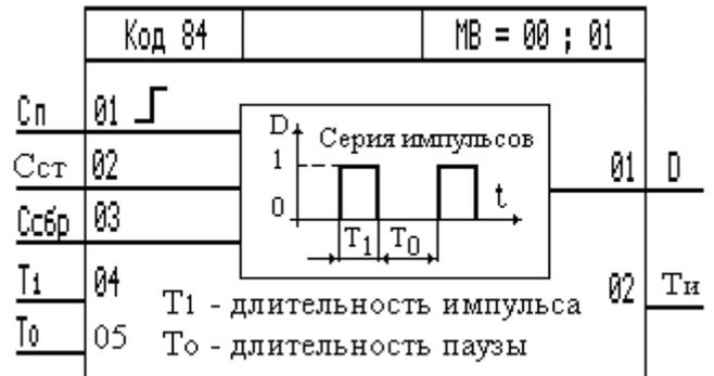
Рис. 14 – Алгоритм МУВ после модификации
