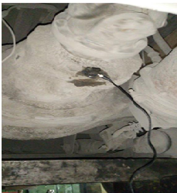
Рис. 1. Крепление датчика на корпусе заднего моста.
