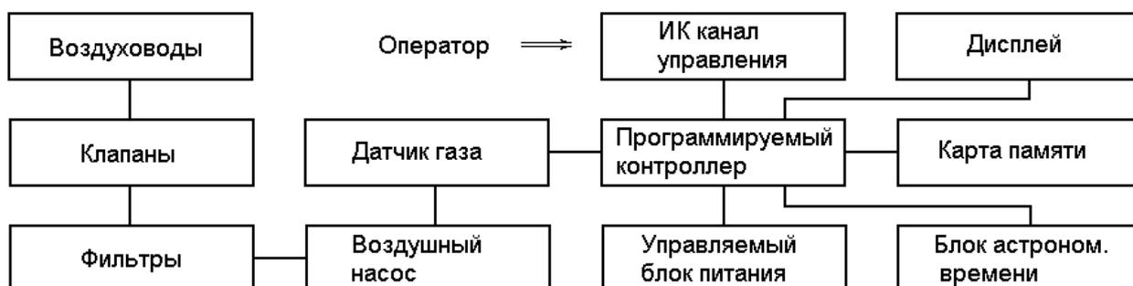
Рис.1. Структура системы управления и прибора.
