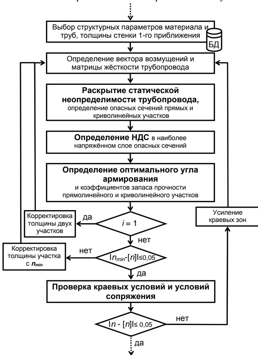
Рисунок 3 - Алгоритм расчёта при создании рабочего проекта трубопровода
