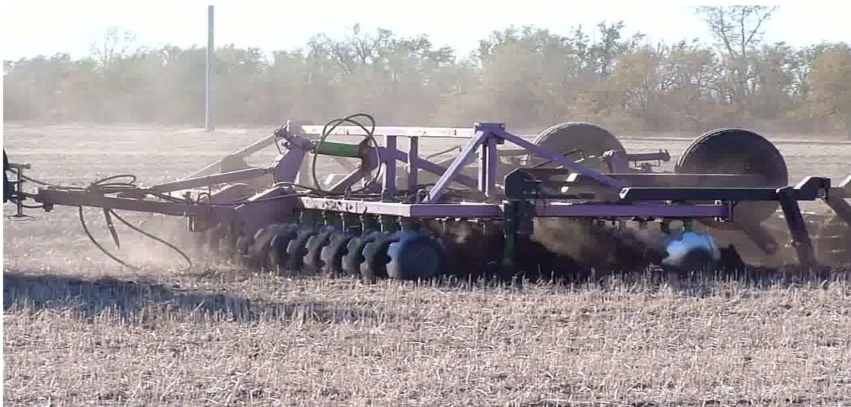
Рисунок 1 – Усовершенствованная конструкция бороны АРГО 5,5×4П в работе
